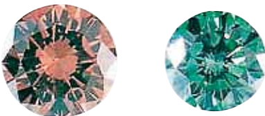
右がアルファ線を照射してブラウンからグリーンに着色したダイヤモンド
