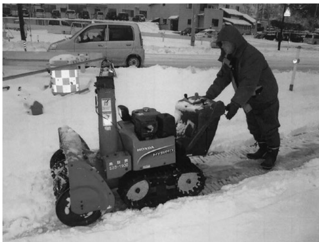
鳥取県から除雪機を借り受けて自治会が集落内を除雪
