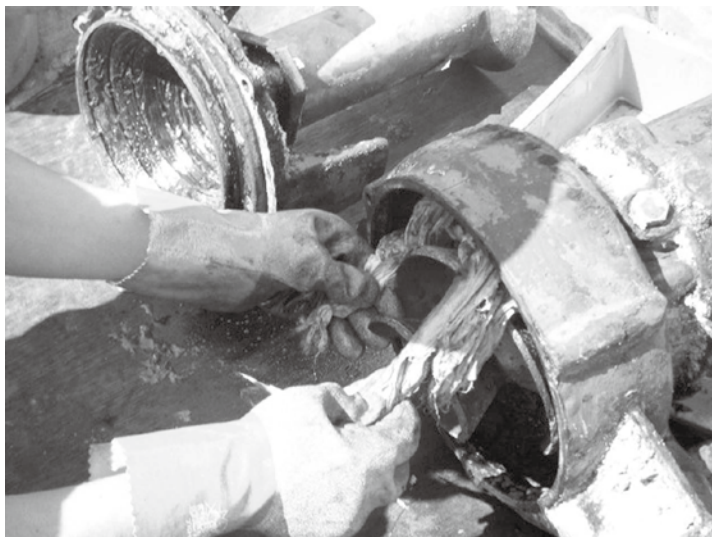
マンホールポンプにタオルや下着が絡まり故障が発生
